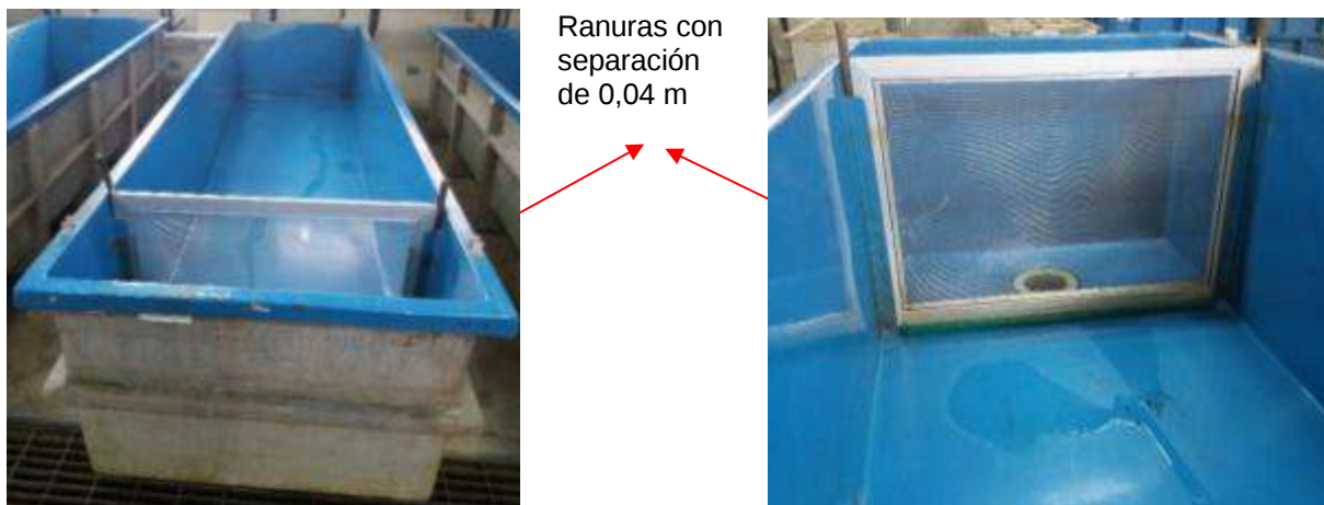
Ilustración 19 Detalle de las ranuras del tanque de alevinaje
